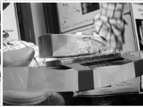
*Le train refroidi à l'azote liquide et lévitant entre deux butées magnétiques.*
